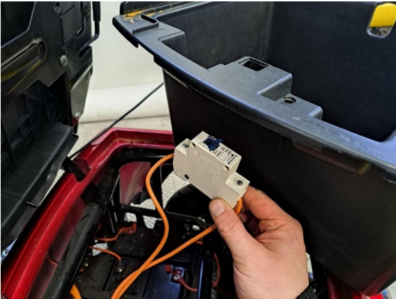
Ota päävirtakatkasija irti säilytyslokerosta. Nosta säilytyslokeron pois.
