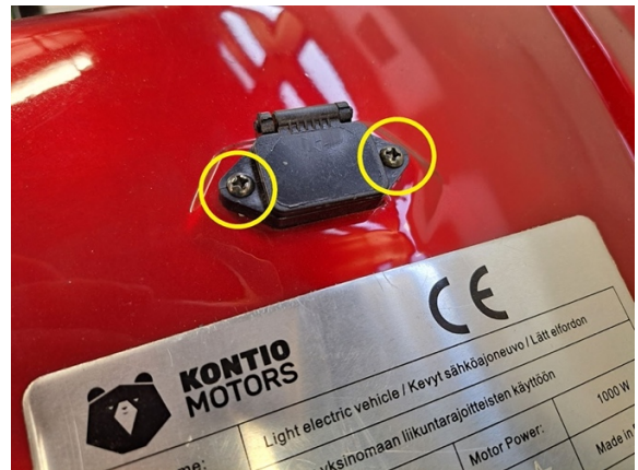
Irrota latauspistokkeen kiinnitysruuvit. (ristipäämeisseli).
