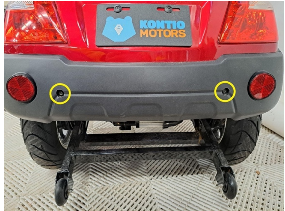
Irrota takakatteen kaksi kiinnityspulttia. (hylsy 8 mm).
