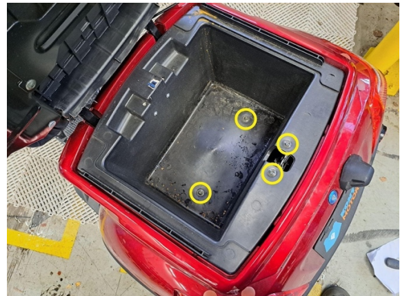
Irrota säilytyslokeron kiinnityspultit. (hylsy 8 mm). Käännä päävirtakatkasija off-asettoon.
