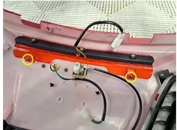
Irrota takakatteen koristevalon kiinnitysruuvit. (ristipäämeisseli).
