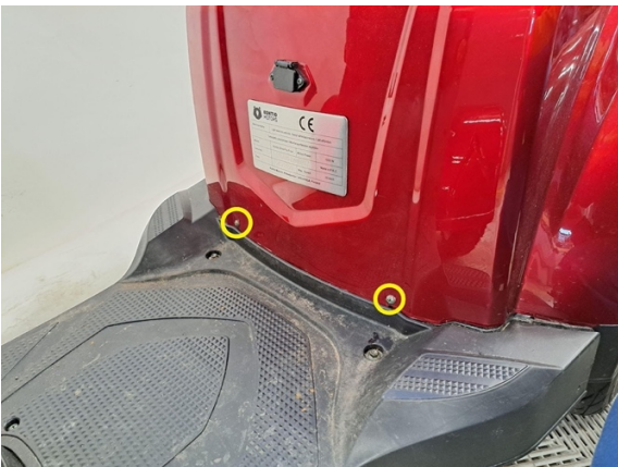
Irrota takakatteen kaksi kiinnitysruuvit. (ristipäämeisseli).
