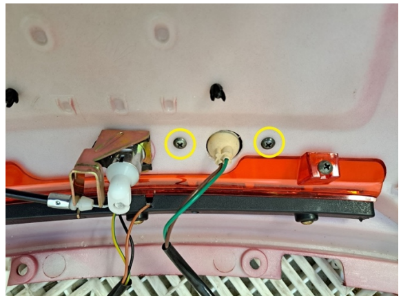
Irrota kilven valon kiinnitysruuvit. (ristipäämeisseli).
