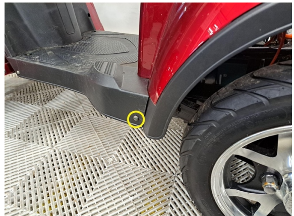
Irrota takakatteen kiinnitysruuvit kummaltakin puolelta. (ristipäämeisseli).
